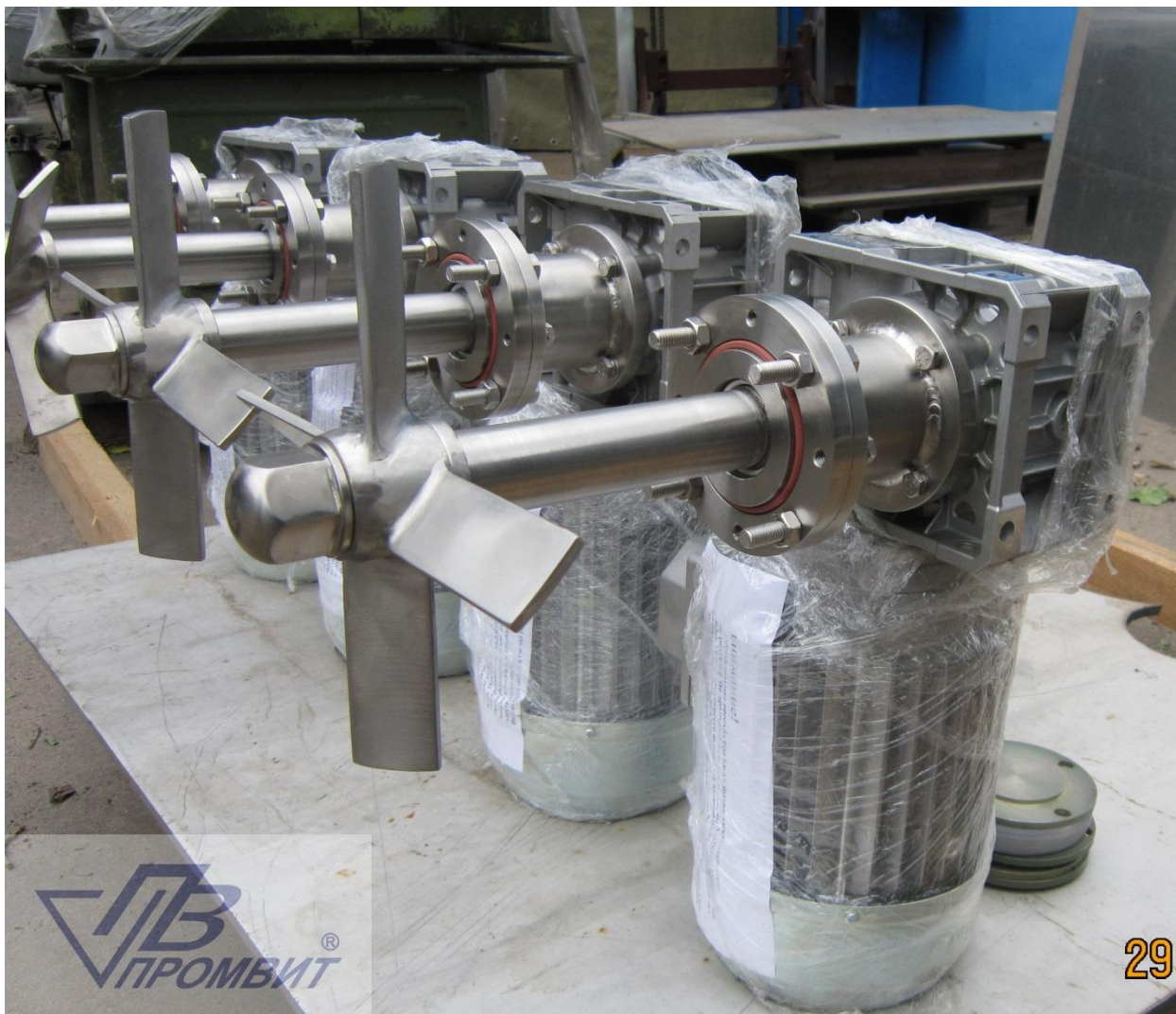
Изготовление мешалок с одинарным торцовым уплотнением для горизонтальных и вертикальных резервуаров.
