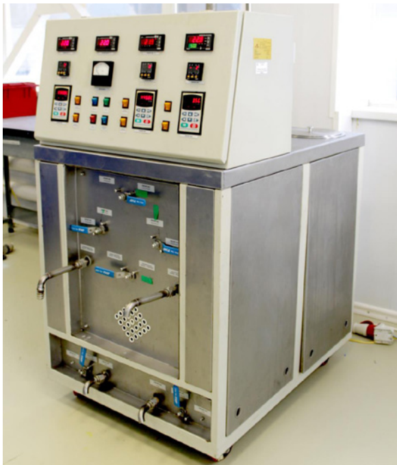
Рис. 3 Гидрокавитационная коллоидная установка с возможностью производства 800 л/кг в час продукта
