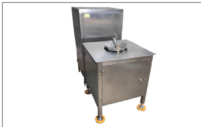
Рис. 2 Электроимпульсная плазменно-динамическая установка для получения экстрактов растительного, животного и минерального происхождения
